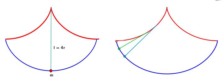
La envolvente del haz de rectas normales a una curva (rectas perpendiculares a la curva en cada uno de sus puntos) se llama Evoluta de una curva y corresponde al lugar geométrico de sus centros de curvatura. La Evoluta de una Cicloide es otra Cicloide.
